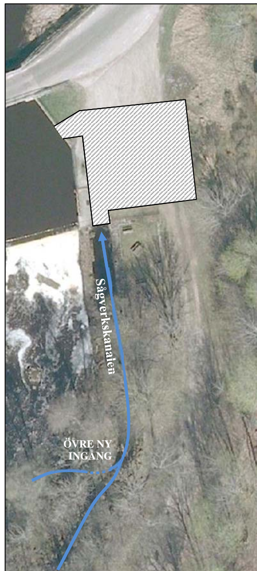
Figur 3b: Fotomontage för trädäck eller annan typ av konstruktion för övertäckning av slitsränna samt lokaliseringen av en ny ingång genom kanalmuren.
