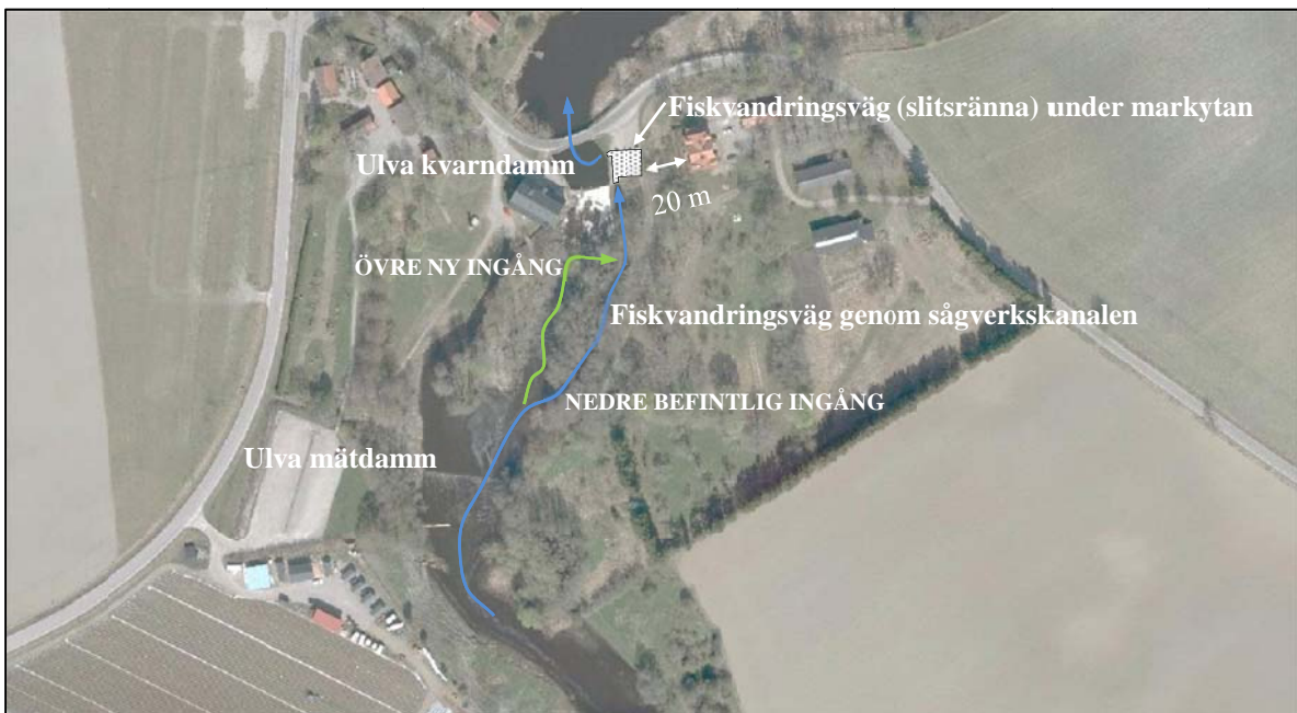
Figur 2. Område vid Ulva kvarn för fiskvandringväg. På bilden illustreras vandringvägen via den befintliga sågverkskanalen med blå pil och en alternativ passage via en ny öppning i kanalmuren med grön pil.
